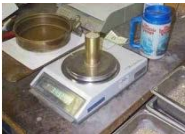
Figura 239 - 4. Determinación de la masa del recipiente con el agregado fino
